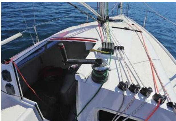
**Asymmetrisch.** Der versetzte Niedergang beeinflusst das Deckslayout: Am Kajütdach ist nur Platz für eine Fallwint, die Genuawinschen befinden sich achtern auf den Sülls. Der Bugspriet wird manuell eingehängt. Vorteil: keine Öffnung im Rumpf, kein Wasser im Schiff
